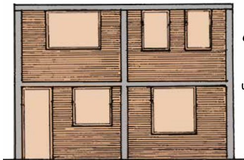
Vanos de ventanas y puertas mal ubicados
