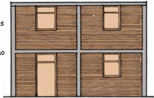
Vanos de ventanas y puertas bien ubicados
